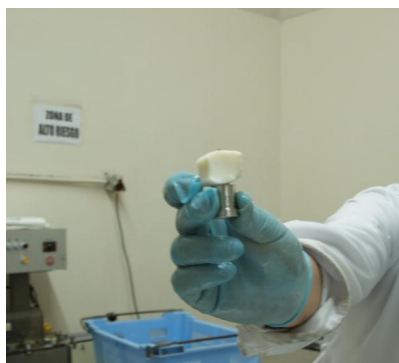
Sensor inalámbrico para la determinación del valor Fo
