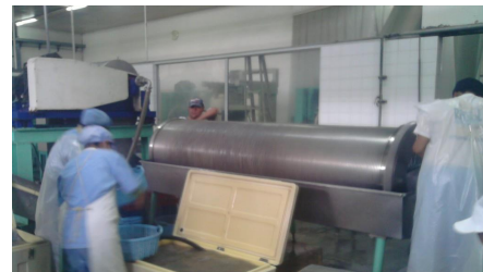
Equipo adaptado para el pelado de la anchoveta
